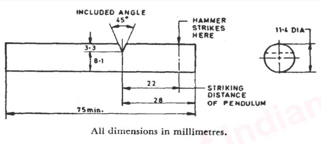
FIG. 5 SINGLE-NOTCH ROUND TEST PIECE
