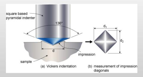
IS1501 / ISO6507-METALLIC MATERIALS — VICKERS HARDNESS TEST IS1501 / ISO6507-METALLIC MATERIALS — VICKERS HARDNESS TEST
