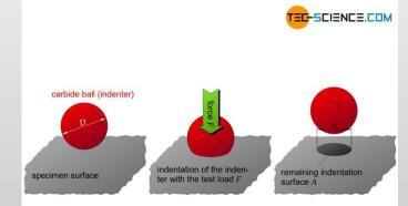
IS 1500 / ISO 6506 -METALLIC MATERIALS – BRINELL HARDNESS TEST
